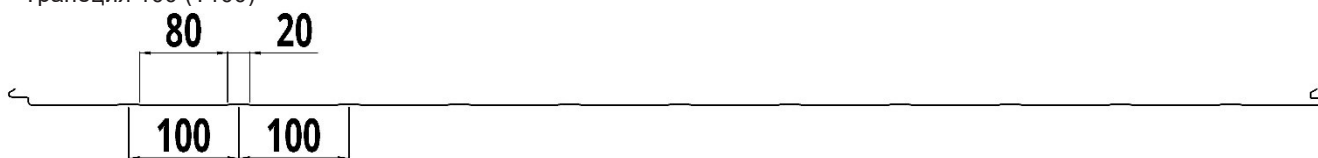
Рисунок 18. Виды профилировки наружной стороны сэндвич-панелей ПСТ Z
